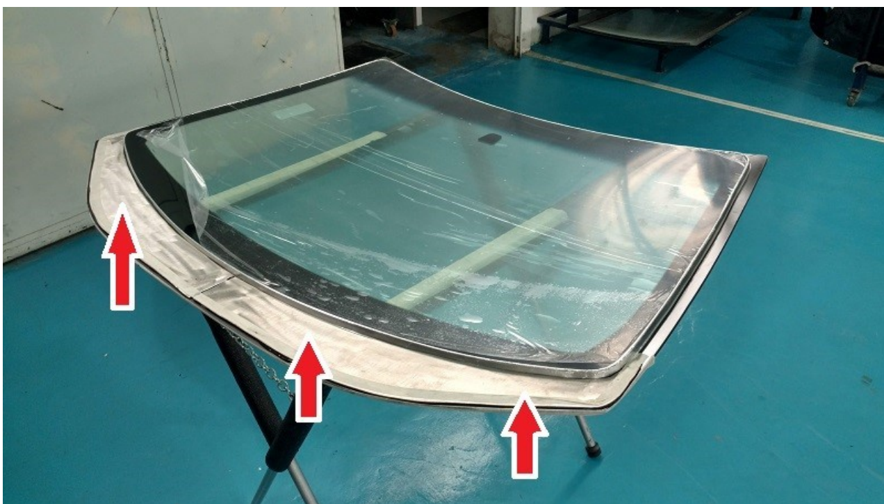
Figura 6 - Reforço em aço inox na região do offset (sorriso) do para-brisa
